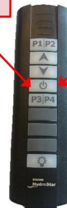
Die Tasten P1-P4 brauchen nur bei verbauter LED-Leuchte angelernt werden. Sind K1-K3 angelernt, lässt sich die Anlage wieder über die Funkfernbedienung bedienen.
